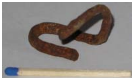
Abbildung 2-2: Im Sturm zerrissenes Kettenglied der Befestigung des Kameragehäuses
