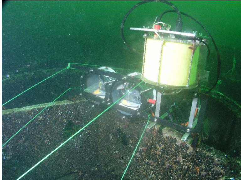
Abbildung 2-1: Befestigung der Kamerakonstruktion auf dem Betonring
