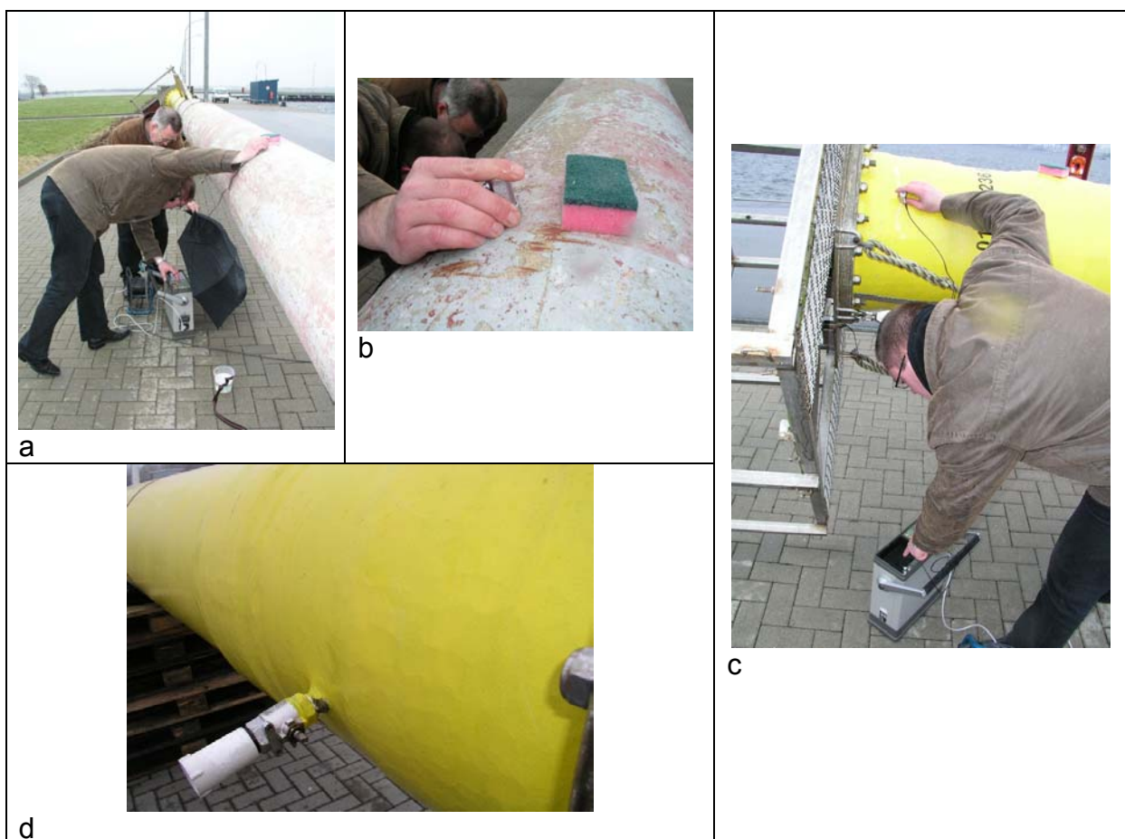
Abb.1.: Zerstörungsfreie Prüfung des Telemetriemastes am Lagerort Marinestützpunktkommando Hohe Düne im Januar 2007
